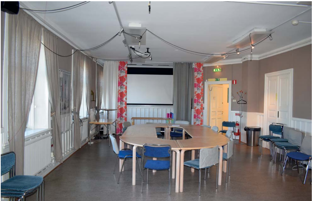
I rum 203 finns bröstningspanel från 1910-talet och flera äldre spegeldörrar. Ytskikten på väggar och golv är moderna.
