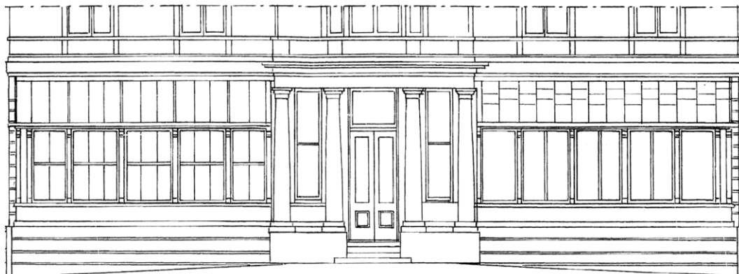
Nuvarande utseende. skjutfönster & glastak. 5 st. takstolar samt poster mellan fönsterna äro av gjutjärn.
